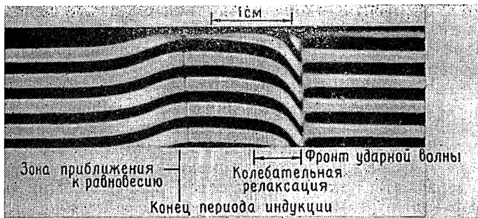
Рис. 2.4. Мгновенная интерферограмма, показывающая профиль плотности за фронтом падающей ударной волны в смеси 1,5% \text{H}_2 —98,5% \text{O}_2 .
