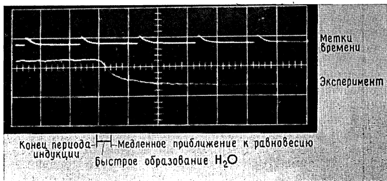
Рис. 2.5. Осциллограмма инфракрасного излучения (2,7 мкм) для реакции в смеси 2,0% \text{H}_2 —2,0% \text{O}_2 —96,0% \text{Ar} [60] за ударной волной.
